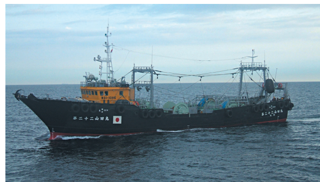
以西底びき網漁船。この漁法では、2そうで1つの大きな網をひきます。【写真提供:山田水産株式会社】
